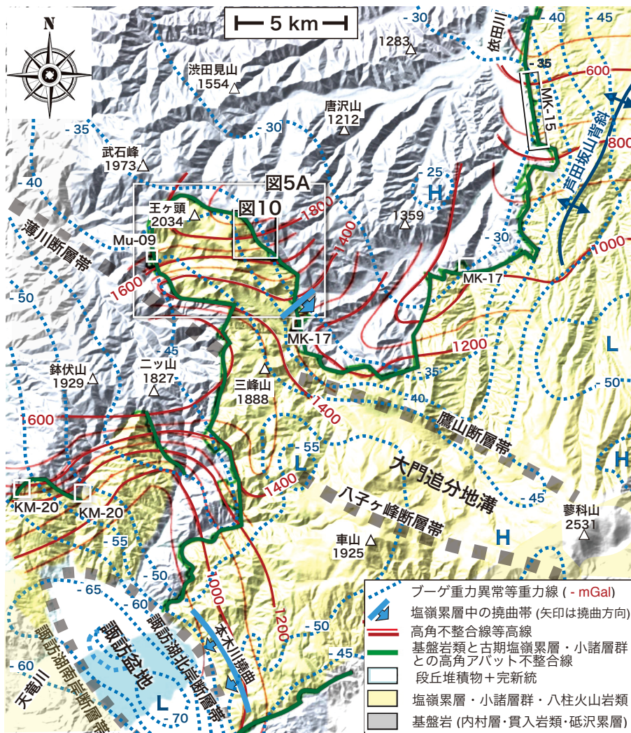
図13 塩嶺火山域周辺のブーゲ重力異常（青色点線）、および基盤岩類と古期塩嶺累層とのアバット不整合面の分布高度（赤色実線）。背景の地形陰影図は、国土地理院50m-mesh DEM dataにより作成。ブーゲ重力異常等重力線（仮定密度：2.0g/cm 3 ）は、中野ほか（1998）からトレース、小四角枠はルートマップおよび露頭で不整合面が推定もしくは確認され記載された位置。記載文献は次のとおり。Mu-09：向井ほか（2009）、MK-15：宮坂・狩野（2015）、MK-17：宮坂・狩野（2017）、KM-20：狩野・宮坂（2020）。
