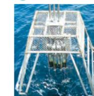
海底堆積物を船上から遠隔採取するマルチプルコアラー:この機器を用いて海底の堆積物試料を採取し、有機炭素や有機窒素の分析に用いる。
