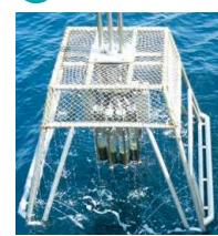
海底堆積物を船上から遠隔採取するマルチプルコアラー:この機器を用いて海底の堆積物試料を採取し、有機炭素や有機窒素の分析に用いる。
