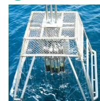
海底堆積物を船上から遠隔採取するマルチプルコアラ:この機器を用いて海底の堆積物試料を採取し、有機炭素や有機窒素の分析に用いる。
