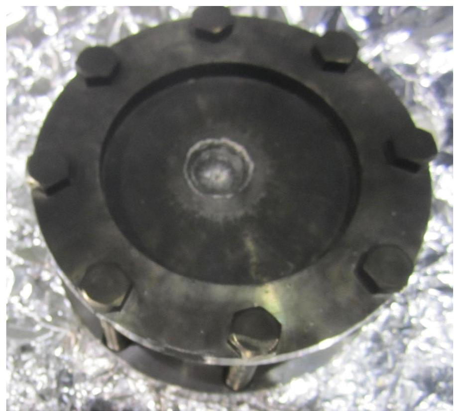
◎ポリカーボネート弾 (速さ $\sim 7$  km/s, 直径7.2 mm)
