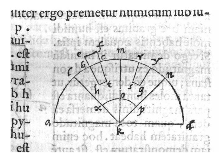
左の物体efhtの重さ = 右のrsgyの部分の水の重さ
