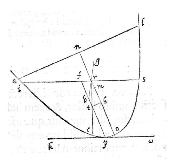
水中に斜めに浮かぶ回転放物体. is は水面. bは水中部分の重心. この場合は真っ直ぐに戻る
