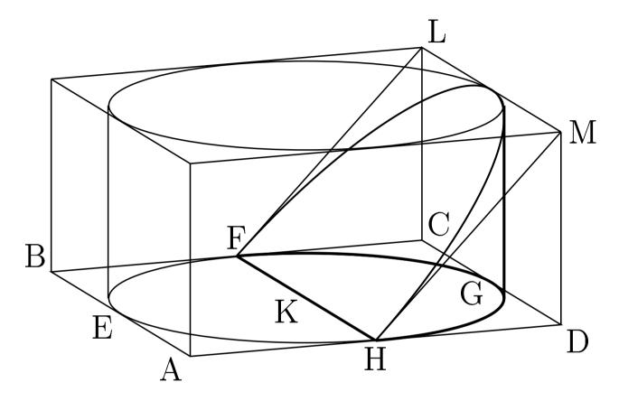
アルキメデスの「円柱の切片」(爪形) 円柱を,底面の直径FHを含む平面で斜めに切ったもの 命題12+13では仮想天秤で体積決定(複雑)
