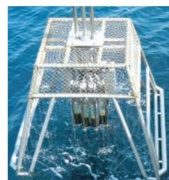
海底堆積物を船上から遠隔採取するマルチプルコアラー:この機器を用いて海底の堆積物試料を採取し、有機炭素や有機窒素の分析に用いる。
