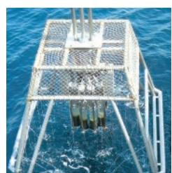
海底堆積物を船上から遠隔採取するマルチブルコアラー:この機器を用いて海底の堆積物試料を採取し、有機炭素や有機窒素の分析に用いる。 |               |
